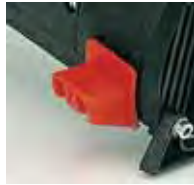
Dispositif de rétablissement du circuit électrique (frein de sécurité).
